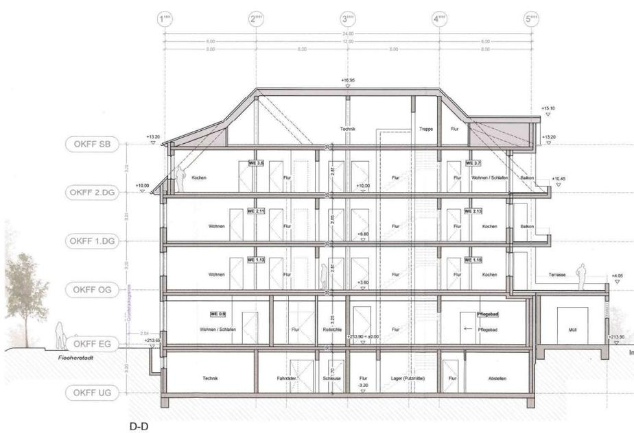
Schnitt durch den Gebäudekörper (Baukörpersegment am östl. Ende/ Bebauung am „Kl. Stadtplatz“ mit 5 oberirdischen Geschossebenen und Tiefgarage)
