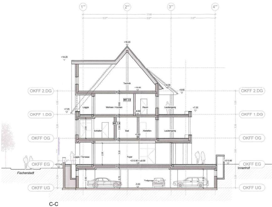
Schnitt durch den Gebäudekörper (Baukörpersegment mit Staffelgeschoss infolge Rücksetzung der Außenwand und Errichtung des Laubenganges; 4 oberirdische Geschossebenen und Tiefgarage)
